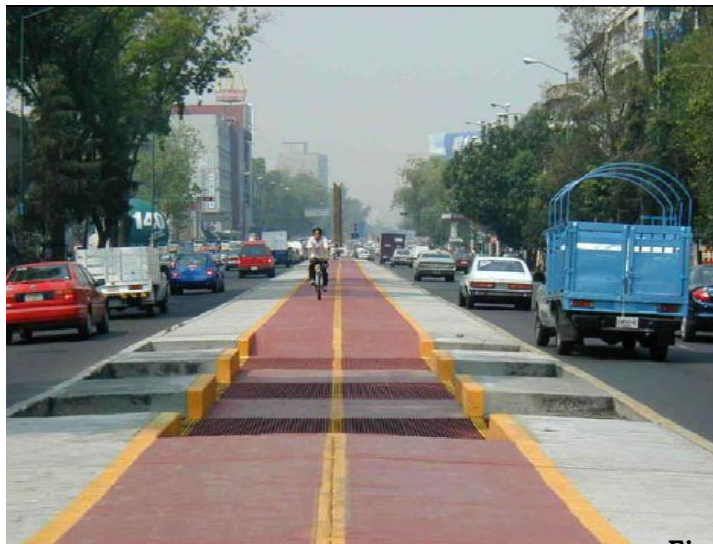
Figura 3-11 - Ciclovia V5-1C Bidirecional - Junto ao canteiro central
